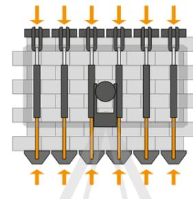
la pinza está compuesta de 6 brazos de apriete individuales (así se asegura una presión óptimas) que están conectados mediante acero de resorte. Por lo tanto, la pinza se adapta a la fila de adoquines incluso en casos de tolerancias extremas.
