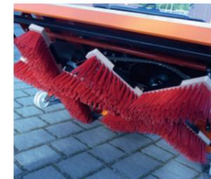
Dos cruces de cepillos giratorios generan un barro de arena y agua, que penetra completamente en las juntas de una pasada.
