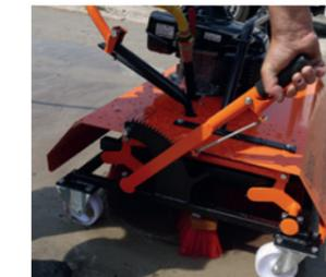
Fácil ajuste de altura para llevar los cepillos a la posición correcta para introducir la arena
